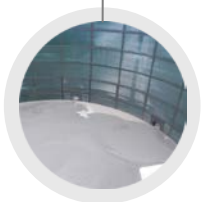
NAPOUŠTĚNÍ NÁDRŽE VODNÍ ZKOUŠKA
